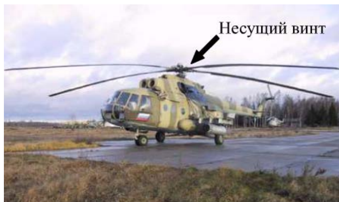
Рис.1.3. Несущий винт
