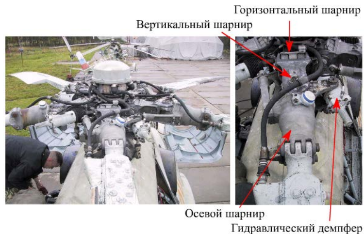
Рис.1.6. Втулка несущего винта
