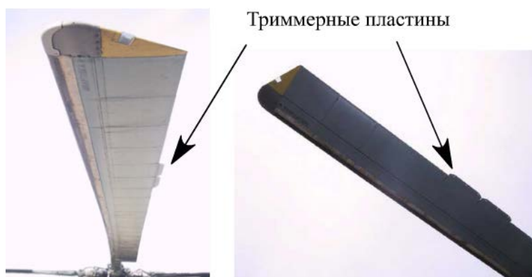
Рис.1.5. Лопасть несущего винта
