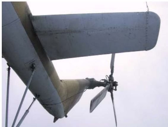
Рис.1.2. Стабилизатор
