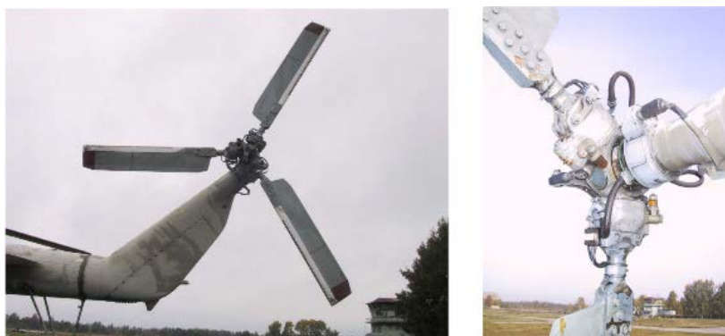
Рис.1.7. Рулевой винт
