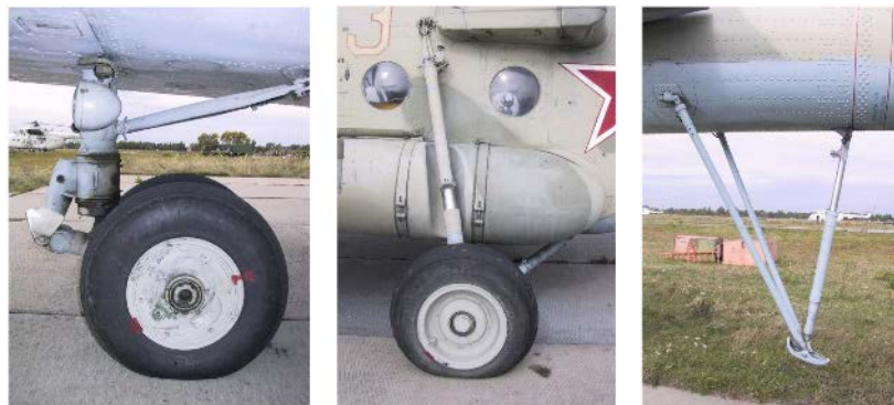
Рис.1.11. Взлетно-посадочные устройства вертолета
