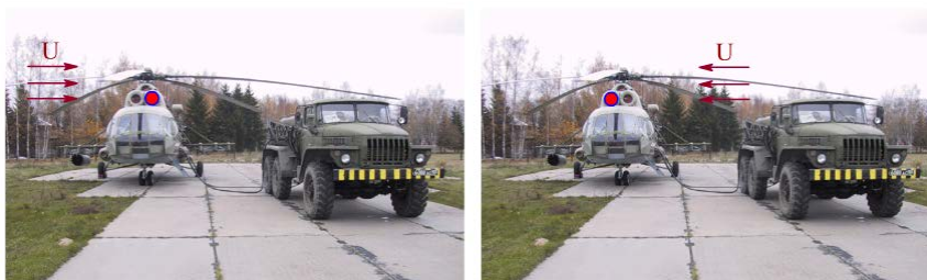
Рис.4.1. Влияние направления ветра на очередность запуска двигателей
